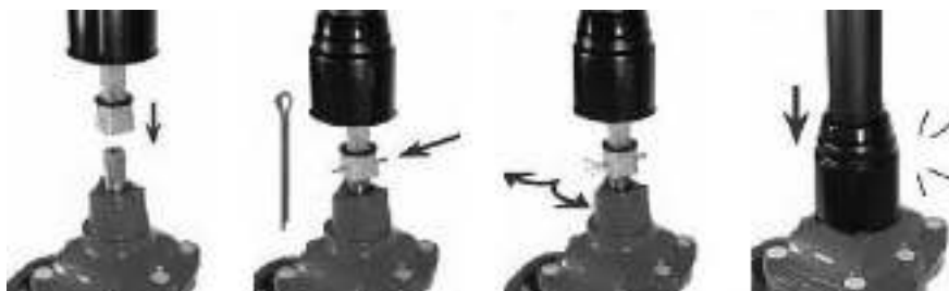
Рис. 4 Порядок установки телескопического штока на задвижку.
